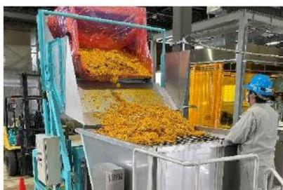
加工工場における残渣原料のライン投入
